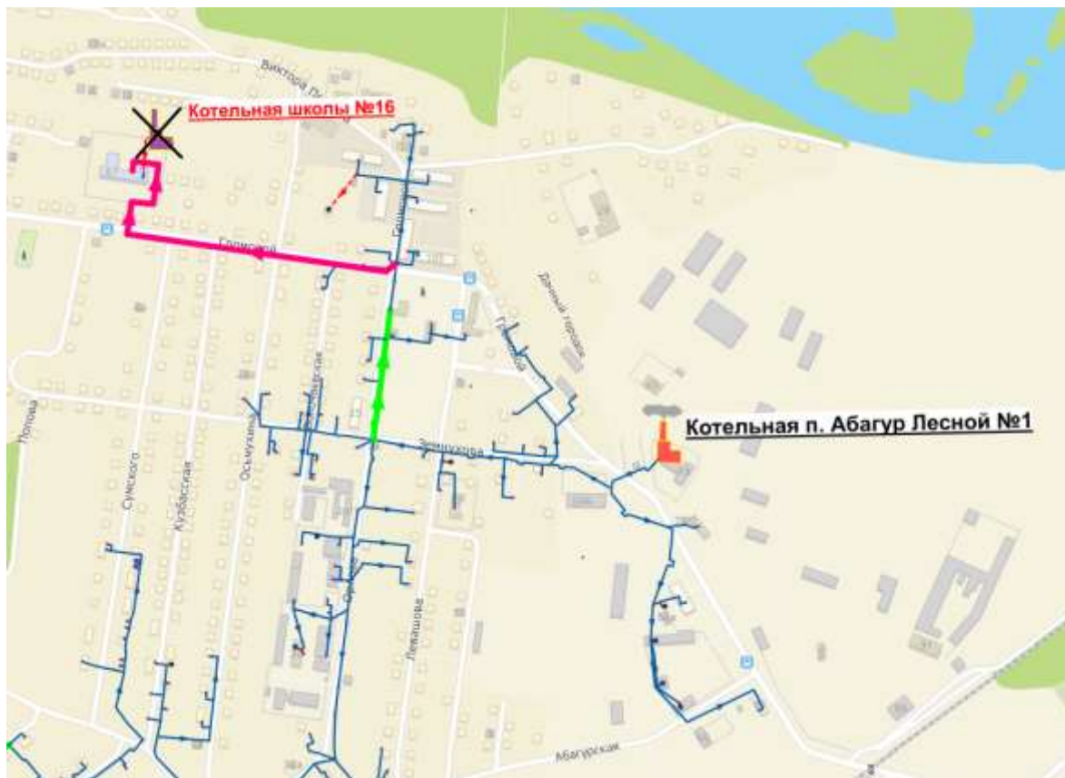
Рисунок 6.11 – Строительство тепловых сетей для переключения котельной школы №16 на котельную №1 п. Абагур-Лесной
